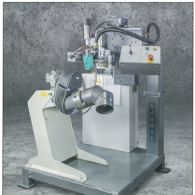
Drehtisch D102/302 auf Sockel mit automatischer Schweißnahterkennung durch Laserabtastung.
