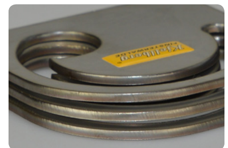
3 mm Edelstahl geschnitten mit HiFinox 3 mm stainless steel cut with HiFinox
