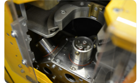
Bestückung mit bis zu acht Brennerköpfen Equipping with up to eight torch heads
