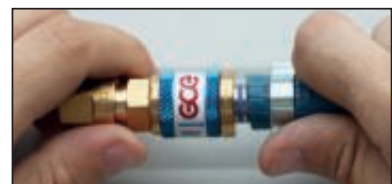
3. Kupplungsvorgang beendet. Der farblich gekennzeichnete O-Ring bleibt sichtbar.
